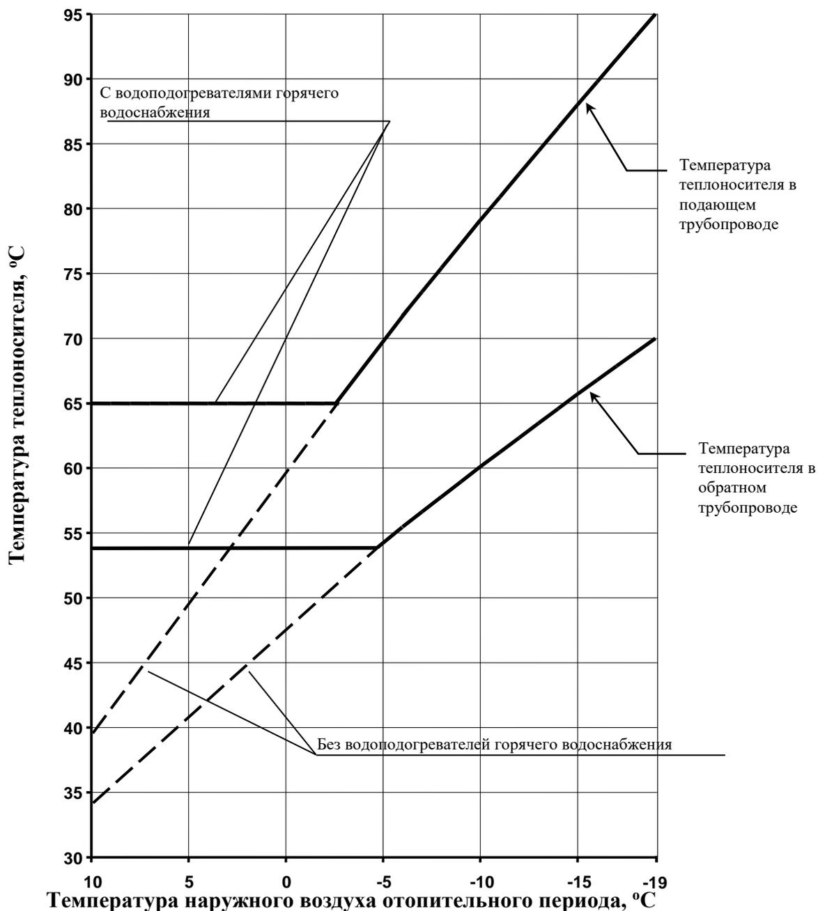
**Примечание:** Температура теплоносителя в обратном трубопроводе от водоподогревателей горячего водоснабжения Заказчика в межотопительный период не должна превышать 40°С.
