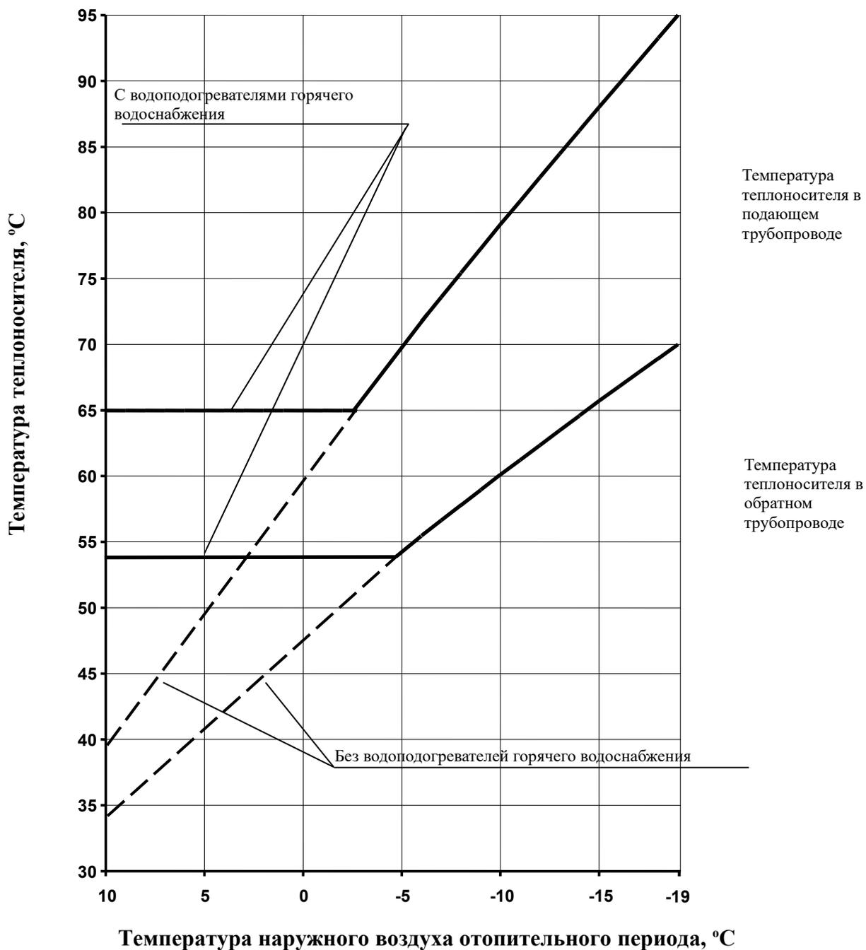
**Примечание:** Температура теплоносителя в обратном трубопроводе от водоподогревателей горячего водоснабжения Заказчика в межотопительный период не должна превышать 40°C.
